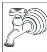
4. Se recomienda tener una canilla exclusiva para la entrada de agua del producto. En su defecto, puede conectar la manguera a la canilla de una bacha o lavadero. Para la instalación de la manguera de entrada de agua se debe utilizar una canilla con rosca de 3/4 de pulgada; si no se utiliza, pueden producirse fugas.
