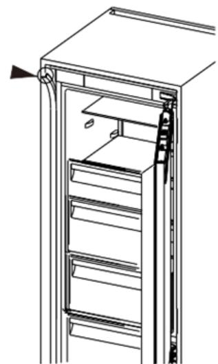
Para asegurarse de que las puertas estén totalmente cerradas/selladas, haga una comprobación en ambas puertas después de instalar la puerta del armario, por ejemplo, utilice un trozo de papel entre la puerta de la unidad y sus juntas y cierre la puerta para ver si se observa alguna tensión al tirar del papel, que debería estar asegurado en su sitio y no se caerá.
